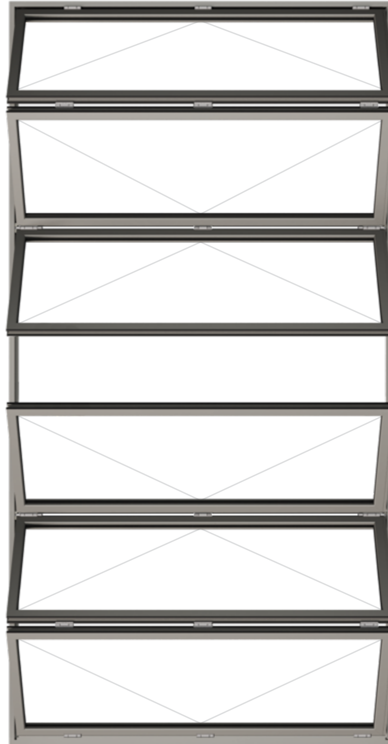
SFD80 | BẢN VẼ LẮP GHÉP | CỬA ĐI XẾP TRƯỢT - 6 CÁNH (3-3)
